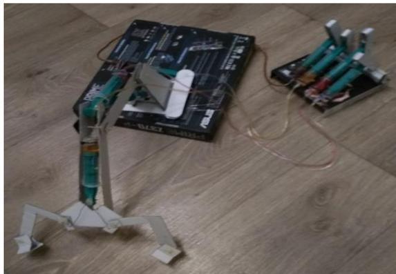
Подсоединил эти шприцы к трубке с другого конца. Теперь самая интересная часть работы – проверка работоспособности. Нажимая на поршни шприцов управления, я увидел, как гидравлическая рука двигается! У руки четыре направления движения. Регулирование высоты стойки, поднимание и опускание стрелы, поворот влево и вправо, смыкание и размыкание клещей.
